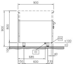
Electrical inlet (power) EQ Equipotential screw
